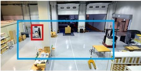
Sobald in einem markierten Bereich eine Bewegung erkannt wird, startet die Aufzeichnung. Um Fehlalarme zu verringern, kann die Empfindlichkeit angepasst werden.
