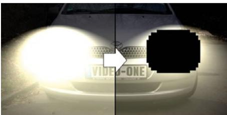
Wird der Sichtbereich der Kamera von Lichtquellen geblendet, werden diese Teile automatisch verdeckt, damit andere Teile nicht überblendet werden. Dies ist zum Beispiel hilfreich bei der Identifizierung von Kfz-Kennzeichen.
