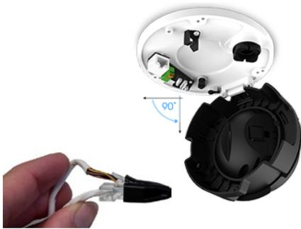
Das Kameramodul lässt sich um 90 Grad kippen. So können Sie die Verkabelung komfortabel in der Kamera verlegen und anschließen.
